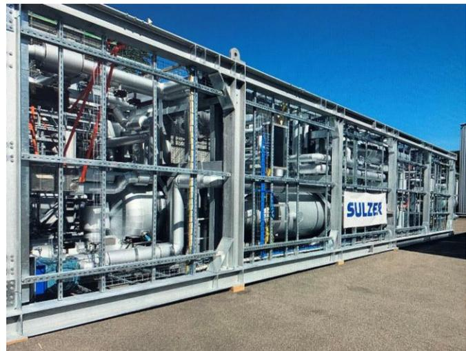
Von dort aus, wird jeder der 43,5 Meter langen und 100-125 Tonnen schweren Transportzüge, welche die Schlüsselkomponenten zur Verbesserung der Carbo-Inden- und Phenol-Produktion des Unternehmens befördern, in einer sorgfältig choreographierten Durchführung durch den Nordeingang des Werks manövriert. Mit den Worten von Bram D'hondt, Vice President Operations und Geschäftsführer der RÜTGERS Germany GmbH: "Ein echtes Abenteuer - nicht einfach, aber gut geplant".
